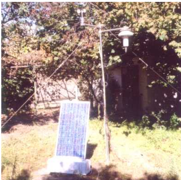
Figura 7. Estación automática de medición de viento, temperatura del aire y humedad relativa.
