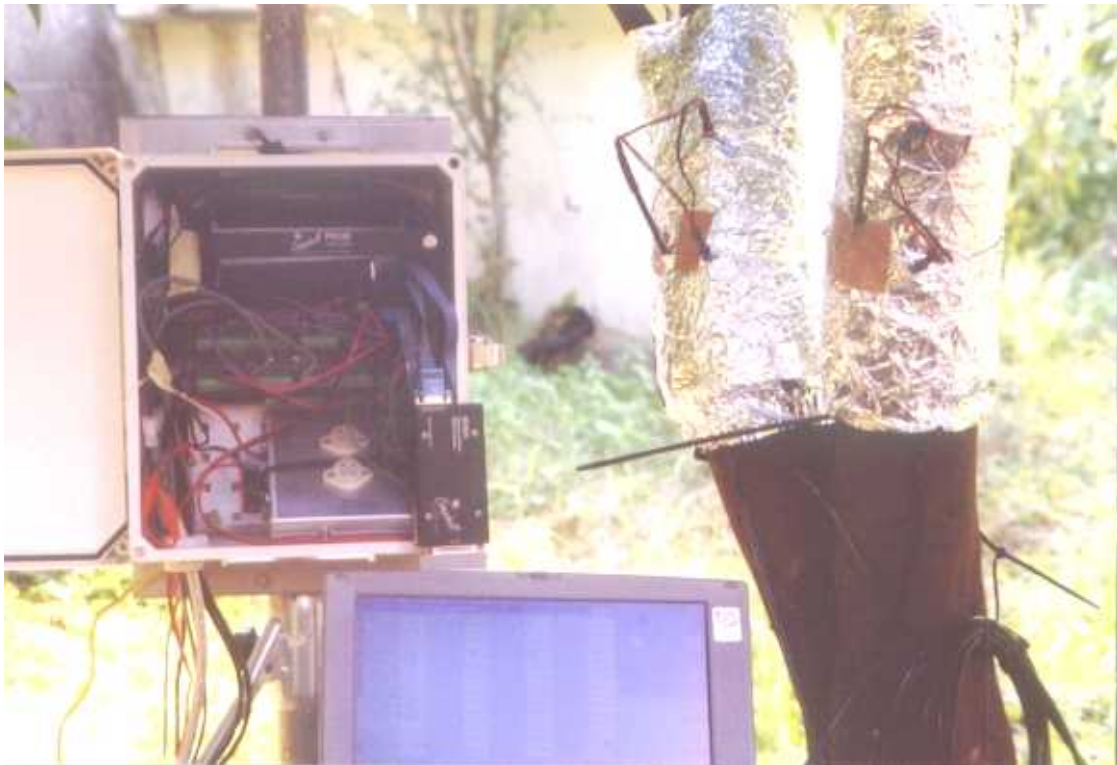
La zona de las ramas donde están insertos los sensores está aislada térmica. Detalle del datalogger
