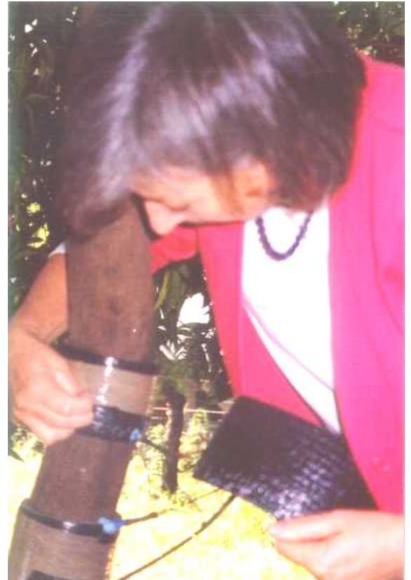
Figura 6. Detalle de la fijación del sensor con enduido plástico e instalación de la placa de aislación térmica.
