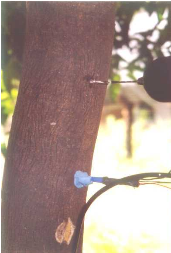
Figura 5. Detalle de la perforación para instalar el tubito de aluminio dentro del cual irá la sonda superior. Vista de la sonda inferior ya fijada al árbol
